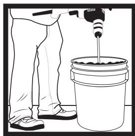
3. Mezclar de preferencia con taladro espada con revolvedor hasta lograr una pasta homogénea sin grumos. Ajustar agregando hasta 1 L de agua para lograr la consistencia deseada.
