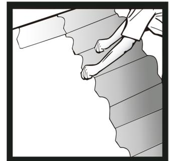
4. Instale la primer hilada vertical de abajo hacia arriba y bajo la misma consideración de adhesivo en costillas y lomo. Termine instalando tejas de abajo hacia arriba y de derecha a izquierda.
