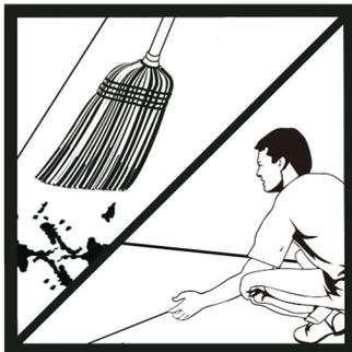
1. Limpiar la superficie para que quede libre de polvo, pintura, aceite, grasa u otros materiales que puedan interferir para una buena adherencia. Escuadre la superficie y marque para facilitar la instalación del hilo nivelador.
