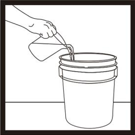
1. Por cada saco de 20 kg agregue en un recipiente de 4,6 a 5,0 L de agua limpia si se usará como reparador, adhesivo o recubrimiento u de 7,2 a 7,8 L de agua limpia si se usará como impermeabilizante.
