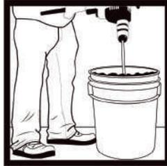
3. Mezclar de preferencia con taladro espada con revolvente hasta lograr una pasta homogénea sin grumos. Ajustar agregando hasta 0,4 L de agua para lograr la consistencia deseada.
