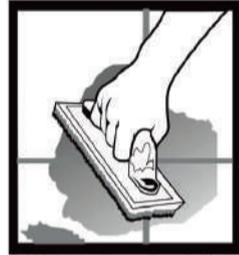
6. Emboquillar ocultando las bases de los niveladores y los separadores.
