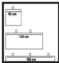
**1.2** Las piezas de hasta 60x60 cm y/o hasta 80kg requieren ranura. Las piezas mayores a 60 cm requieren un anclaje adicional por cada 60 cm.
