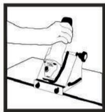
**1.** Montar el pulidor en la base especial para pulidor y hacerle ranuras en diagonal en la parte trasera de las losetas a instalar.
