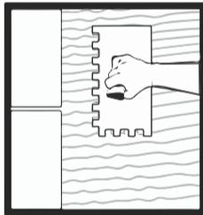
2. Aplicar la pasta sobre la superficie y extender de forma homogénea usando la parte lisa de la llana. Rayar la pasta con la llana dentada procurando una inclinación de 60° y trazando líneas rectas paralelas al lado de la pieza a instalar.
