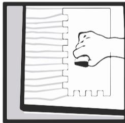
3. Aplicar adhesivo en la cara posterior de la pieza cerámica trazando líneas rectas paralelas a las líneas de la pasta en la superficie.
