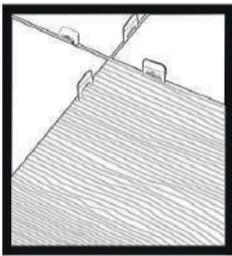
1. Con la pasta fresca en la superficie, colocar niveladores aproximadamente de 5 a 8 cm del borde a la pieza a colocar.
