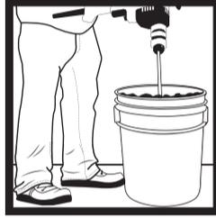
3. Mezclar de preferencia con taladro espada con revolvedor hasta lograr una pasta homogénea sin grumos. Ajustar agregando hasta 0,4 L de agua para lograr la consistencia deseada.
