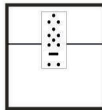
**2.** Insertar un anclaje mecánico en cada ranura.
