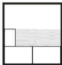
**1.** Aplicar adhesivo en el muro con lana dentada formando rayas horizontales y aplicar adhesivo también en la parte trasera de la loseta formando rayas paralelas al muro.
